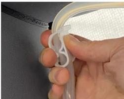
« Clamp » fermé : ne laisse pas passer l'air (position lorsque la structure est gonflée)
