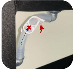
« Clamp » fermé : ne laisse pas passer l'air (position lorsque la structure est gonflée)
