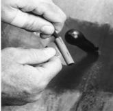
Coloque el insertador de alambre a la mitad de la parte expuesta del plug. Retire la película protectora del plug y aplique una capa fina de cemento vulcanizante en esta parte del plug. Como lubricación, aplique un poco de cemento en el insertador de alambre donde hace contacto con el plug.
