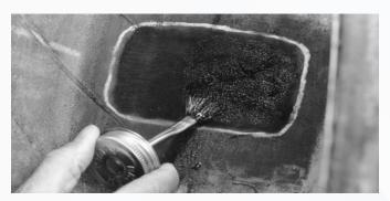
Con el uso de una brocha, aplique una película fina y uniforme de cemento vulcanizante sobre el área que fue raspada. Deje secar de 3 a 5 minutos; el cemento vulcanizante deberá sentirse pegajoso. En zonas con altos niveles de humedad puede requerir más tiempo de secado. Asegúrese de que el cemento que está usando sea compatible con los parches que está usando para la reparación.
