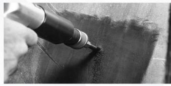
Prepare la perforación con el buril del tamaño adecuado usando un taladro de bajas rpm (1200 rpm máx.). Siguiendo la dirección de la herida, perfore de adentro hacia afuera. Hágalo tres veces. Repita este proceso, pero ahora de afuera hacia adentro para asegurar que las cuerdas dañadas y el hule han sido removidos (tenga cuidado al taladrar de no hacer más grande la herida de lo que está).
