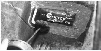
Para proteger el área raspada en llantas sin cámara, deberá aplicar un sellador sobre las orillas del parche y el área raspada. Si es de una llanta con cámara deberá usar grafito en polvo para evitar que se pegue la llanta con la cámara.
