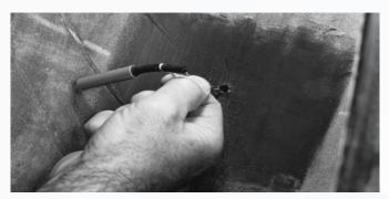
Retire el punzón en espiral e introduzca la punta del insertador de alambre por la herida desde adentro de la llanta.
