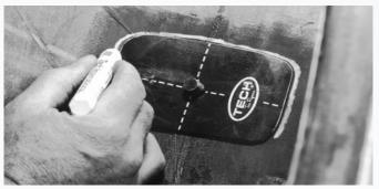
Por dentro de la llanta, coloque la plantilla del parche adecuado sobre el plug, asegúrese de alinear la plantilla con respecto a las cejas y dibuje el contorno de la plantilla sobre la llanta.
