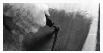
Usando el punzón en espiral, aplique cemento líquido vulcanizante en la perforación desde adentro de la llanta. Gire el punzón a la derecha, metiendo y sacando el punzón. Repita de 3 a 5 veces. Deje el punzón en la herida mientras continúa con el siguiente paso.
