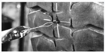
**3** Jale el insertador de alambre desde afuera de la llanta hasta que el plug se encuentre en su posición. Si el insertador de alambre se zafa del plug, utilice unas pinzas y jale el plug hasta que este cubra bien la herida, quedando expuesto aproximadamente ½" (13 mm) de la parte más gruesa del plug por fuera del piso de la llanta.
