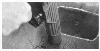
Aspire todo el polvo y residuos que hayan quedado en la llanta. Si toca o contamina la superficie raspada después de la limpieza, deberá repetir el paso 11 para garantizar que la superficie está completamente limpia.
