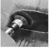
Utilice un mototool neumático de bajas rpm (5000 rpm máx.) y una carda; raspe el plug hasta dejarlo al nivel de la capa hermética. Luego raspe suavemente el área marcada hasta alcanzar una superficie con textura RMA-1 o RMA-2. Utilice un cepillo de alambre suave y limpio para remover el polvo y los residuos del área raspada.
