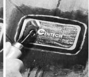
**Retire por completo el plástico protector de la goma del parche.** Mediante el uso de la carretilla, deslícela firmemente sobre el parche del centro hacia afuera. Retire el plástico superior protector del parche.
