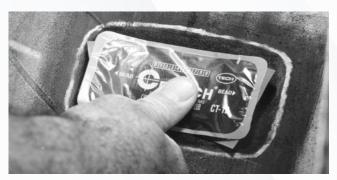
Con las cejas de la llanta en posición relajada, centre el parche sobre el plug que acaba de ser colocado. Presione con el dedo el parche sobre el plug. Asegúrese de que las flechas del parche apuntan o están alineadas hacia las cejas y presione con el dedo. Deslice hacia afuera los plásticos que protegen al parche. Esto le permitirá manejar el parche sin que contamine la goma que trae el parche. Ahora hay que pegar bien el parche.
