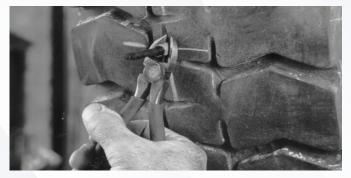
Corte el excedente del plug por la parte exterior de la llanta, dejando 1/8" (3 mm) por encima de la superficie de la llanta. La llanta está lista para ser regresada al servicio.
