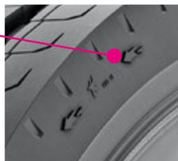
Sin embargo, si una llanta marcada con flechas bidireccionales muestra un desgaste irregular atribuible a esta condición, puede ser puesta a girar en la dirección de la flecha más pequeña y no mostrar disminución en el desempeño. En estos casos, MICHELIN® recomienda que todas las llantas de un mismo eje sean puestas a girar en la misma dirección.
