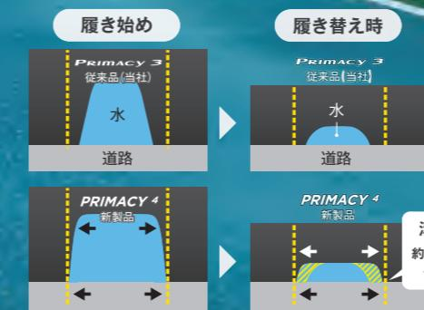
新溝形状の採用により、濡れた路面での排水性能が向上。MICHELIN PRIMACY 3と比較して履き替え時の溝体積が約22%アップ。
