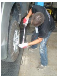
Rodízio dos conjuntos e aperto da roda com torquímetro.
