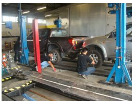
Rodízio dos conjuntos e aperto da roda com torquímetro.
