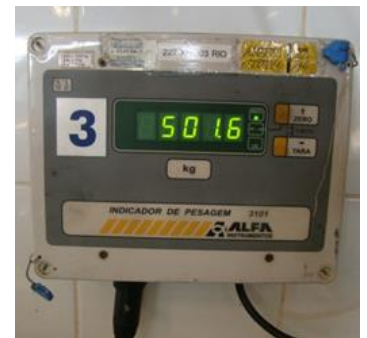
B-2 Pesagem da repartição de carga do veículo, por eixo e por conjunto montado com 4 balanças de precisão.
