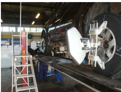
B-3 Verificação e regulagem dos valores da geometria de direção conforme medidas fornecidas pelo fabricante do veículo.
