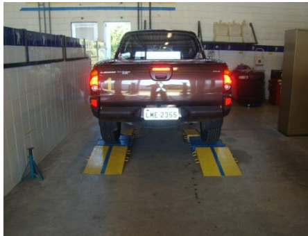
B-2 Pesagem da repartição de carga do veículo, por eixo e por conjunto montado com 4 balanças de precisão.
