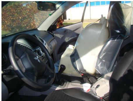
B-1 Colocação de lastro no banco efetuando simulação de passageiro.
