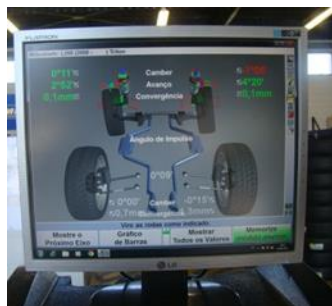
B-3 Verificação e regulagem dos valores da geometria de direção conforme medidas fornecidas pelo fabricante do veículo.
