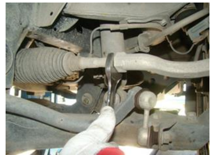
B-3 Verificação e regulagem dos valores da geometria de direção conforme medidas fornecidas pelo fabricante do veículo.
