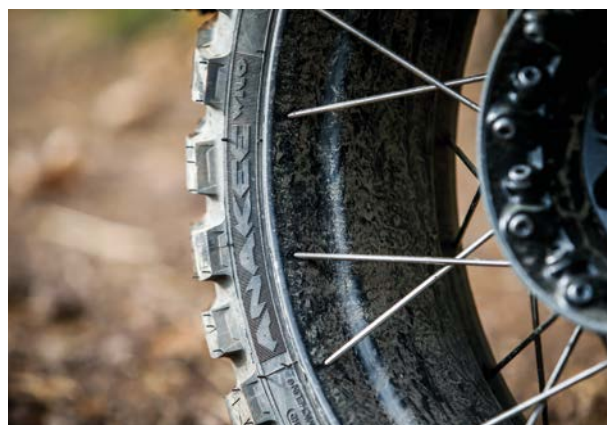
Une jante à rayons Tubeless (TL) : les rayons sont fixés sur les carres en maintenant l'étanchéité.
