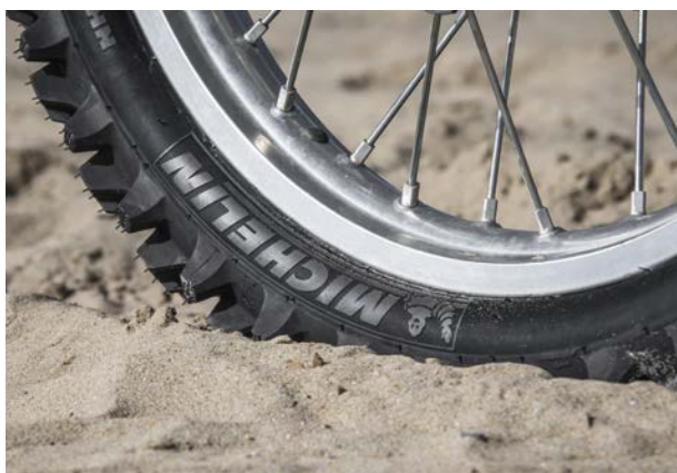
Une jante Tube Type (TT) : les rayons percent la jante au centre.
