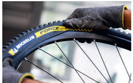
**Eine kurze Fahrt wird helfen, die Versiegelung gleichmäßig über den ganzen Reifen zu verteilen und seine abdichtende Wirkung zu optimieren. Der Reifendruck sollte vor jeder Fahrt überprüft und angepasst werden. Die optimale Luftdichtigkeit wird möglicherweise erst nach mehreren Tagen des Einsatzes erreicht (in Abhängigkeit der Kombination von Dichtmittel und Reifen).**
