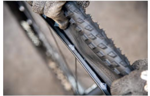
Positionieren Sie auf jeder Seite des Ventils (mit ca. 5 cm Abstand) vorsichtig einen Reifenheber und wenden Sie beide Hebel gleichzeitig an, um den Reifen über den Haken der Felge zu ziehen.
