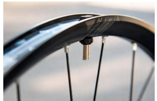
Den Reifenwulst in die Felge einführen und sicherstellen, dass die Rotationsrichtung des Reifens mit der der Felge übereinstimmt. Diesen Vorgang auf der gegenüberliegenden Seite des Ventils beginnen und am Ventil beenden.
