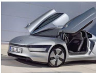
MICHELIN ET VOLKSWAGEN ONT ÉTROITEMENT COLLABORÉ POUR OPTIMISER LES PERFORMANCES ÉNERGÉTIQUES DE LA NOUVELLE VOLKSWAGEN ONE LITER : ELLE EST ÉQUIPÉE DE PNEUS MICHELIN ENERGY™ SAVER DE GRAND DIAMÈTRE ET FAIBLE LARGEUR SPÉCIALEMENT CONÇUS POUR ELLE.
