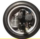
— La roue intègre la suspension, le frein et le moteur alimenté par une batterie ou une pile à combustible. Cette innovation de rupture, emblématique de la créativité technique de Michelin, rend inutiles l'embrayage, l'arbre de transmission et le différentiel. De quoi repenser complètement l'automobile et contribuer à préserver l'environnement.
