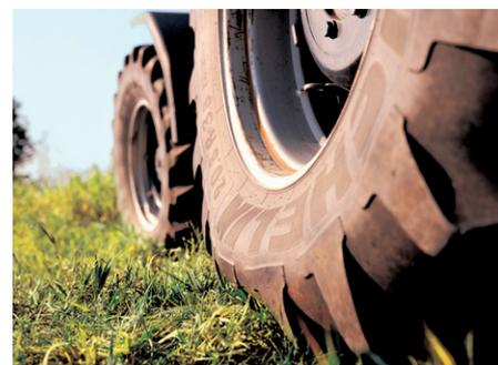
Grâce à MICHELIN UltraFlex Technologies, **l'empreinte au sol augmente de 20 % à iso charge et iso dimension\***. Cela signifie que le sol est moins compacté et donc mieux préservé.
