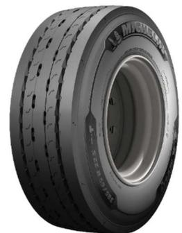
(1) indice de charge augmenté : changement de classe d'indice de charge pour le MICHELIN 385/65 R 22.5 X<sup>®</sup> MULTI<sup>™</sup> HLT (164K) en comparaison avec le MICHELIN 385/65 R 22.5 X<sup>®</sup> MULTI<sup>™</sup> T (160K), soit l'équivalent de + 1 tonne à l'essieu.
