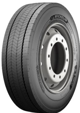
Afin de procurer toujours plus de sécurité, une attention particulière a été portée à la protection des flancs régulièrement en contact avec les bordures de trottoirs. Un témoin d'usure, sur le côté indique lorsqu'il devient nécessaire de permuter les pneus.
