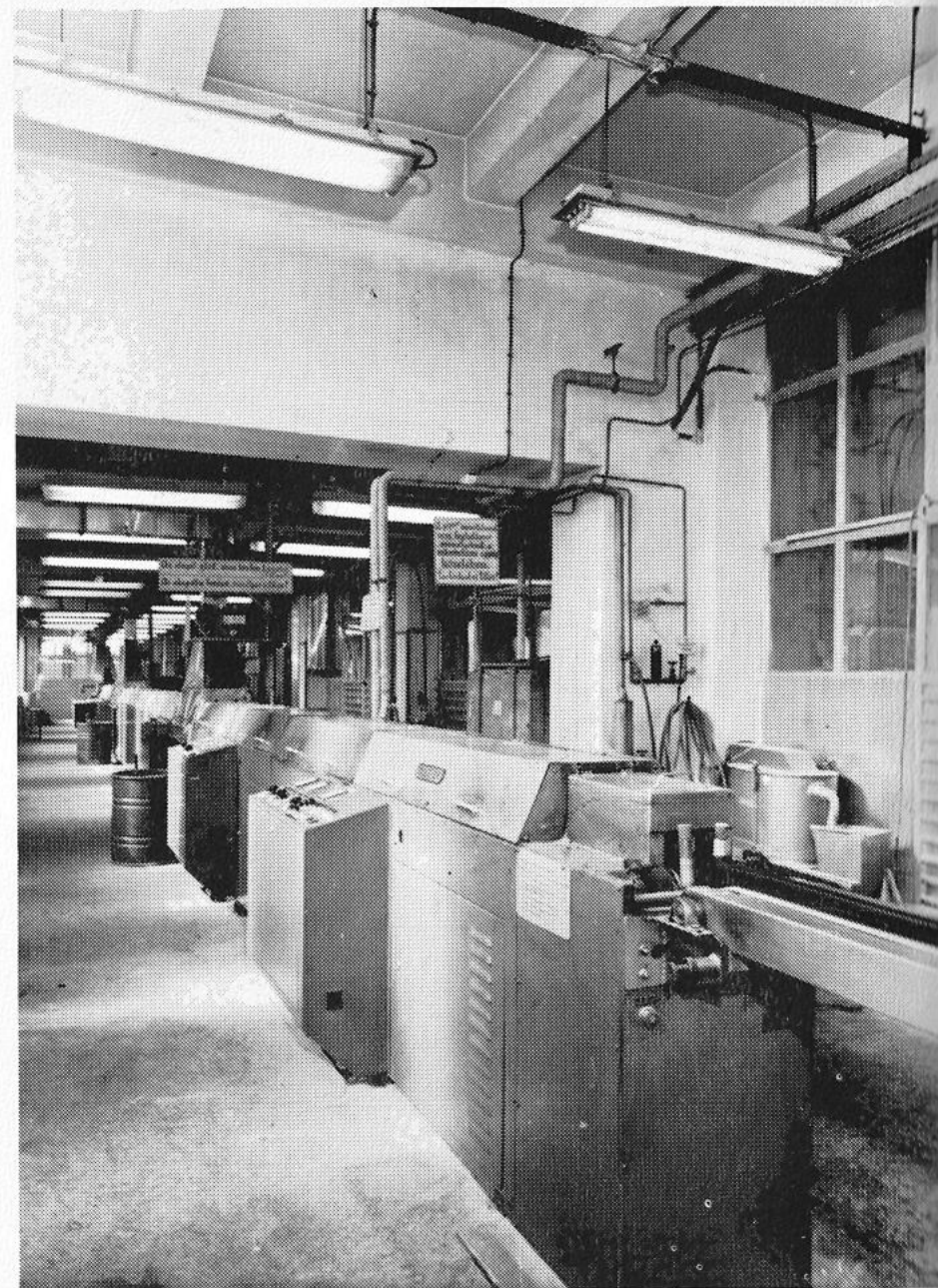
Nagyfrekvenciás fűtésű folyamatos profilszalag-vulkanizáló berendezés a Műszaki Gumigyárban
