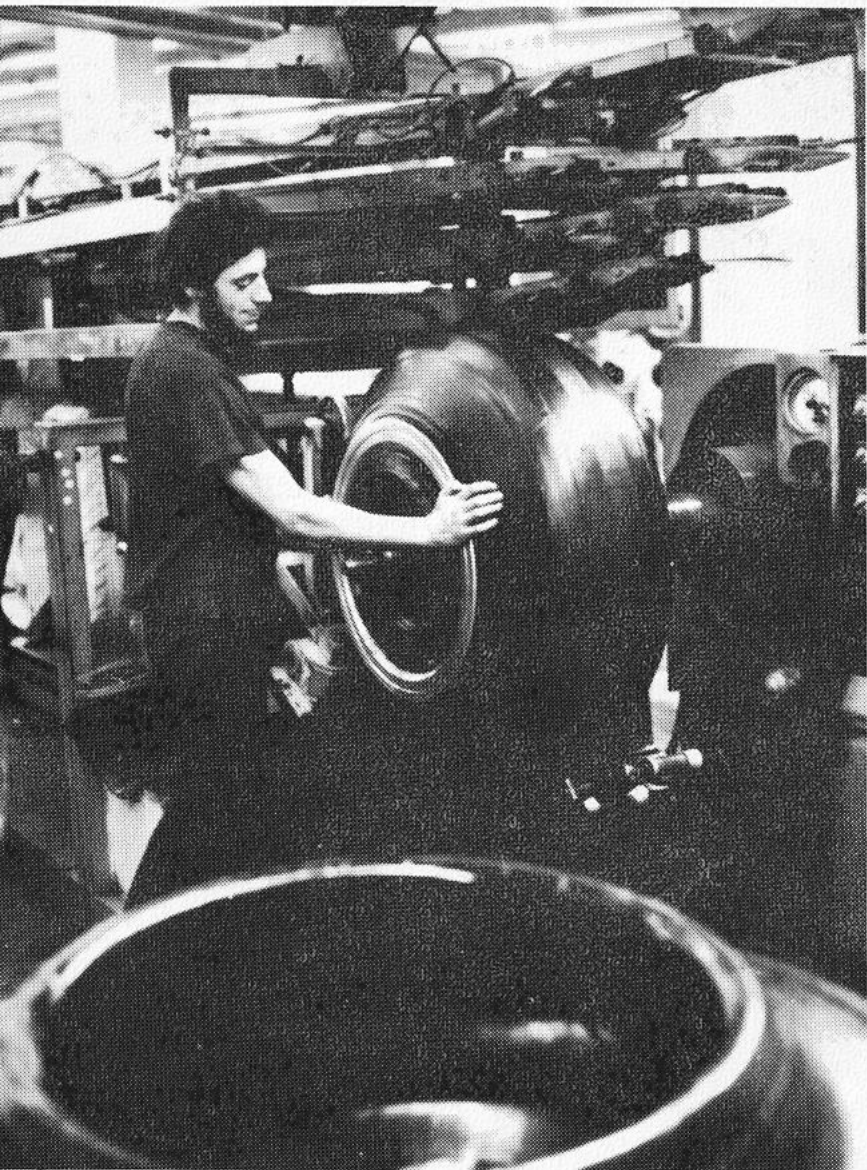
Acélradiál felépítés az Abroncsgyárban (Budapest)
