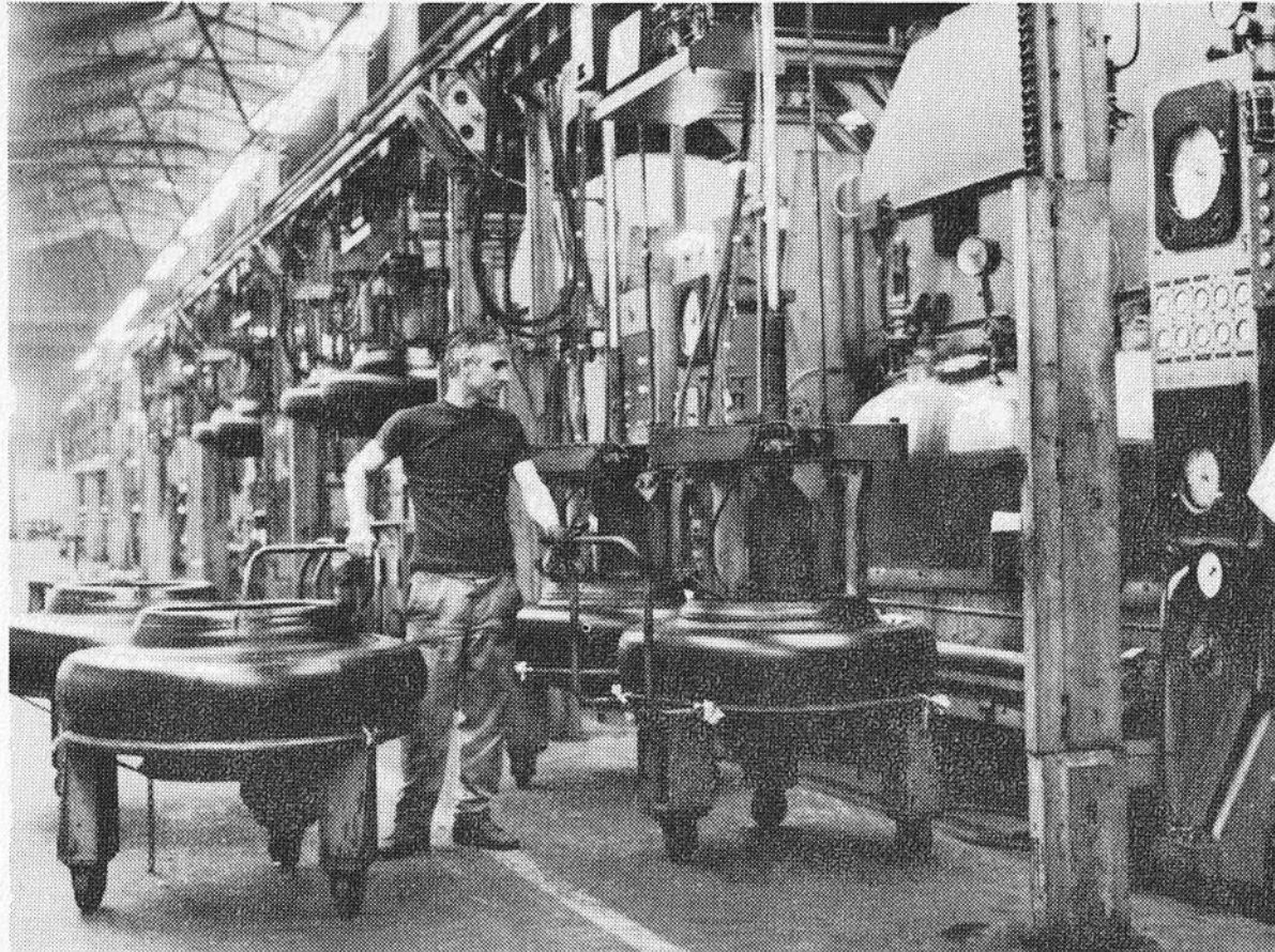
Acélradiál vulkanizáló csarnok az Abroncsgyárban (Budapest)
