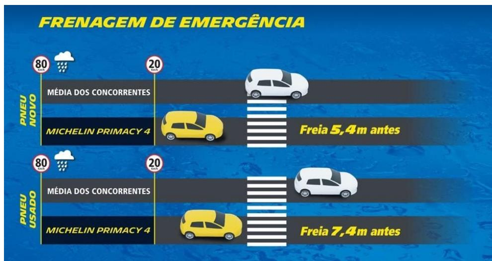
\* Teste de frenagem em piso molhado de 80 a 20 km/h, realizado pelo TUV SUD por solicitação MICHELIN, entre junho e julho de 2017, com pneus 205/55 R16 montados em um Volkswagen GOLF VII 1.4 TSI, que compara o pneu MICHELIN PRIMACY 4 com os concorrentes BRIDGESTONE TURANZA ER300, CONTINENTAL POWERCONTACT, GOODYEAR EFFICIENT GRIP PERFORMANCE e PIRELLI CINTURATO P1 PLUS.
