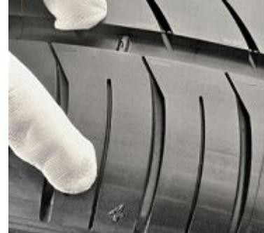
“Além do Indicador de Desgaste, é importante verificar se existem deformações no pneu, cortes, materiais encrustados como pedras, cacos de vidro ou mesmo prego e parafusos e se o desgaste da banda de rodagem parece normal. Caso haja qualquer anormalidade, deve-se levar o veículo para um especialista fazer uma verificação mais técnica para avaliar se o dano observado pode ser reparado ou se é necessário substituir os pneus”, explica o engenheiro.
