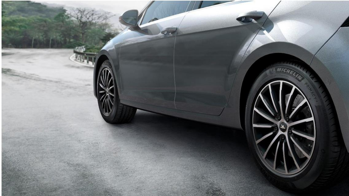
A segurança se traduz pelo desempenho superior de frenagem em piso molhado, seja quando novo ou já usado, devido à tecnologia MICHELIN EverGrip, uma combinação inteligente de duas camadas de borracha com diferentes níveis de rigidez. Essa inovação permite que a banda de rodagem se adapte, independentemente do nível de desgaste do pneu, proporcionando um ganho real de aderência.
