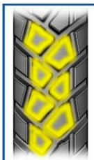
MAIS TRAÇÃO EM ON E OFF: máxima tração, seja qual for o terreno, devido aos blocos alternados na banda de rodagem.
